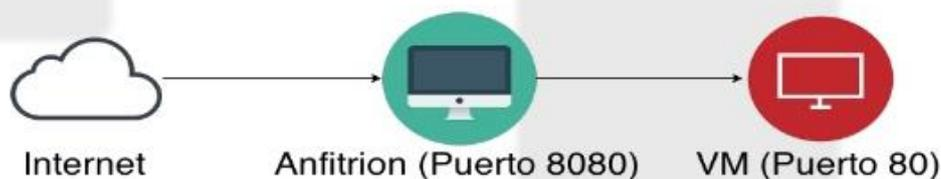
Una funcionalidad muy útil y sencilla es la redirección de puertos de la red por defecto que utiliza Vagrant (red interna con NAT). Configura un Vagrantfile para que las peticiones al puerto 8080/tcp de la máquina anfitriona se redirijan al puerto 80/tcp de la máquina virtual.
